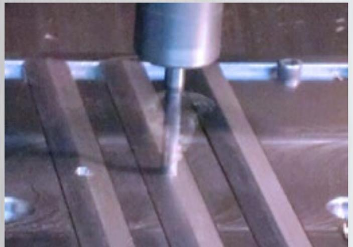
*hergestellt aus rostfreiem Profilstahl 15 x 3,5 mm mit hoher Festigkeit nach DIN / FAS 11333 / 2.2
